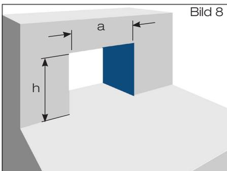
**Festlegung des Wanddurchbruchs in der Attika, Festlegung der Einbauhöhe, Einbindung des LORO- Schiebeflansches in die Dampfsperre**
